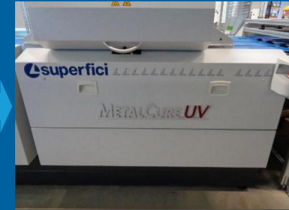
❁ Trocknung des Drucks mit 4 UV-Röhren
