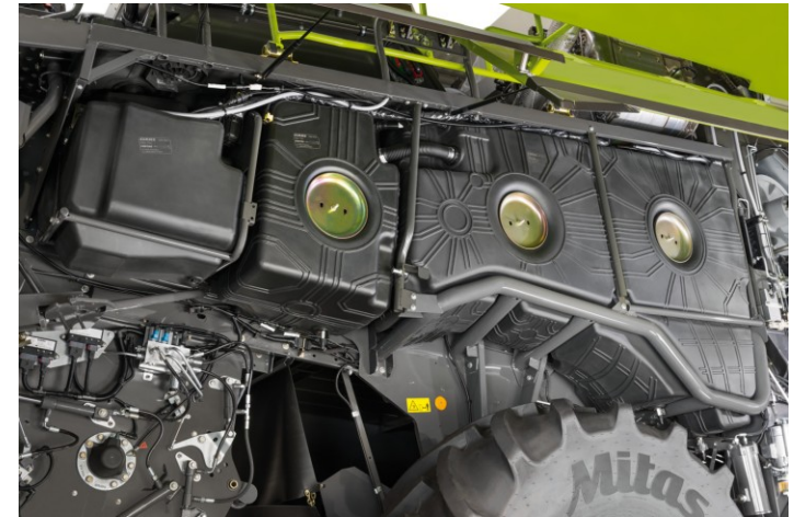
Bauraumbedarf eines Dieseltanks für einen Mähdrescher
